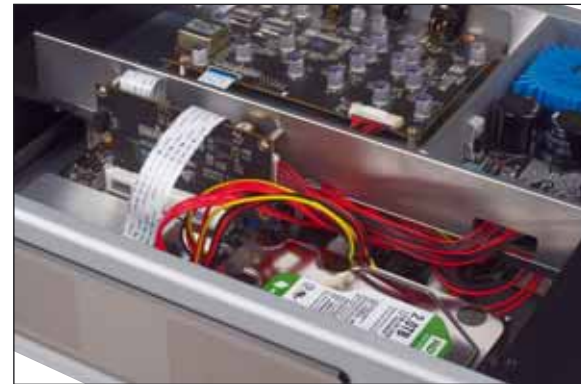
Das für die Signalverarbeitung verantwortliche Board wird von einem separaten analogen Netzteil versorgt
