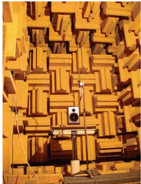
Der Schalltoter Raum, die „Messhalle“
