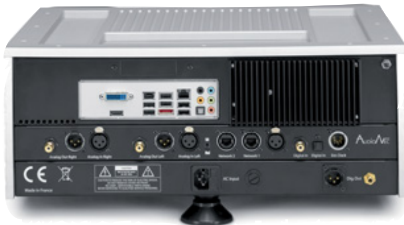
Strengste Trennung, obwohl unter einem Dach – von oben nach unten: Musikserver, D/A-Wandler mit (optionaler) Vorstufe, Netzteil. Und ganz ohne Bildschirm geht's nicht ...
