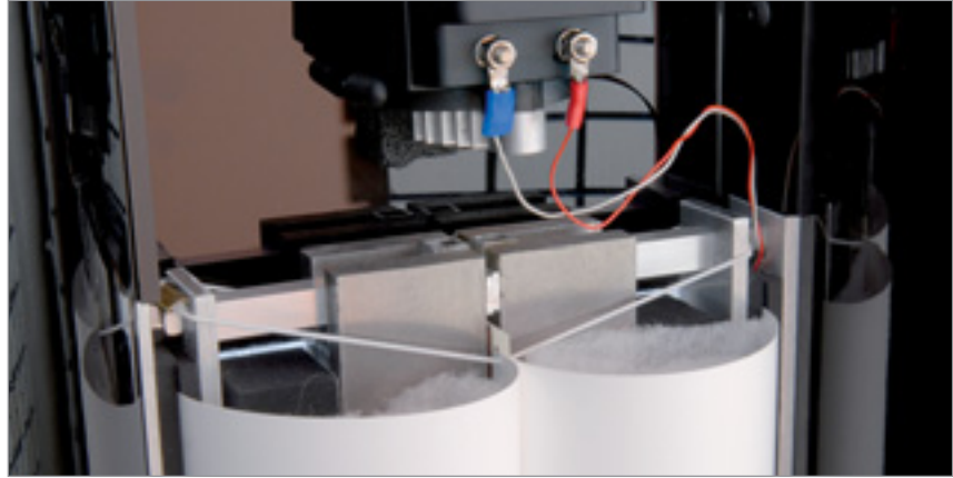
Sensationell: Den effizienten Mittelhochtöner „Janus 50“ mit Dipol-Spaltmembran und elektrodynamischem Antrieb über die gesamte Vertikale fertigt AudioNec in Lizenz
