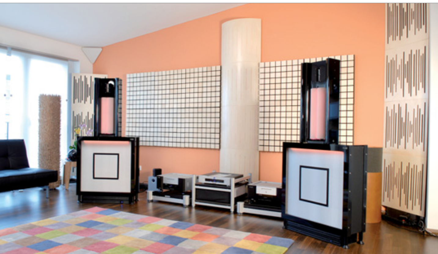
Chamäleon: Dank DSP-basierter Raumakustik-Korrektur passt sich das AudioNec-System jedem Umfeld perfekt an. Gleiches gilt im übertragenen Sinne auch für die fernsteuerbare Illuminierung der Schallwandler per LED
