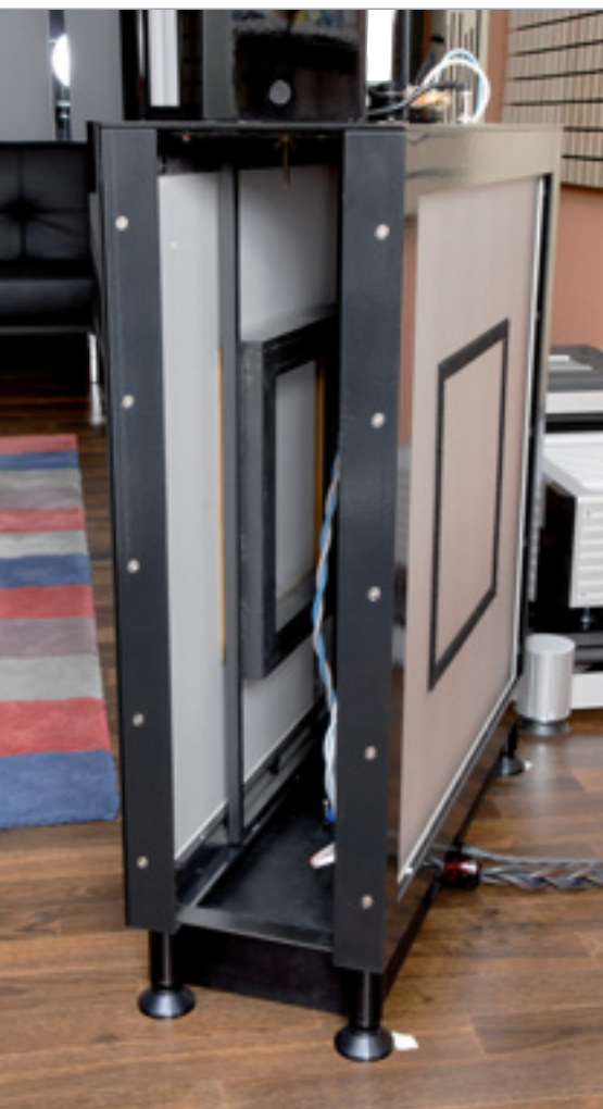
Doppel-Dipol: Stahlrahmen mit Quadrat-Membranen, darunter die 800-W-Endstufe
